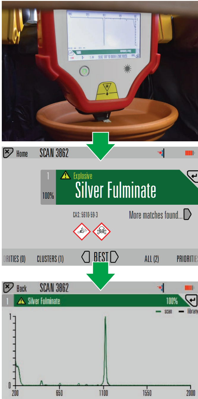
그림 3. 범위 검사 사례: Agilent Resolve 시스템을 사용한 silver fulminate 분말의 point-and-shoot 식별
