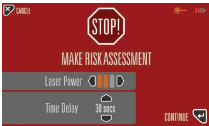
Figure 2. Écran d'évaluation du risque pour le paramétrage du temps de retard et la réduction de la puissance du laser
