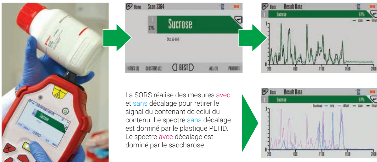
Figure 4. La SORS associe des mesures avec et sans décalage, pour obtenir un spectre de grande qualité correspondant au contenu d'un récipient.
