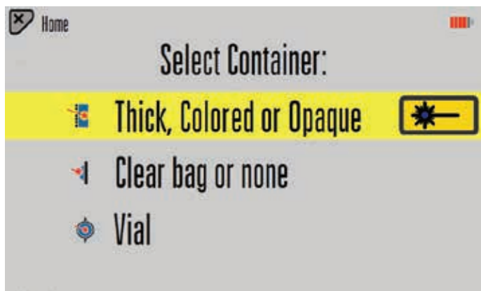
Figure 1. Sélections destinées aux mesures à travers les contenants, « visée et déclenchement » (« point-and-shoot ») ou flacon en verre
