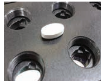
Posicionamento de um comprimido em uma bandeja de aprimoramento de feixes.
