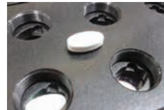
Posizionamento di una compressa in un vassoio di potenziamento del fascio luminoso
