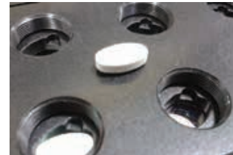
Positionnement d'un comprimé sur un plateau d'amplification de faisceau
