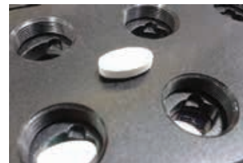
Positionierung einer Tablette in einer Strahlverstärker-Probenträger
