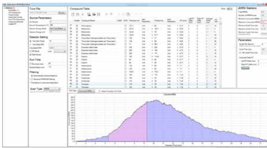
Figura 6. Un metodo dynamic MRM contenente un grande numero di analiti e transizioni, con il delta del tempo di ritenzione a sinistra e a destra impostato su 2 minuti, ha superato il numero massimo di MRM concomitanti.
