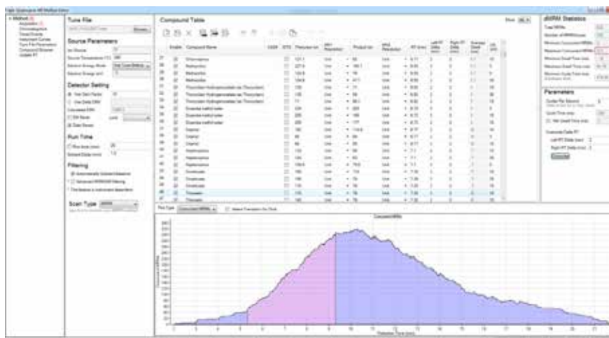
Abbildung 6. Eine dynamische MRM-Methode mit einer großen Anzahl an Analyten und Übergängen überschreitet die Anzahl an gleichzeitigen MRMs bei Festlegung des linken und des rechten Retentionszeit-Deltas auf 2 Minuten.
