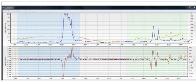
图 4. MPhunter 的屏幕截图，蓝色为聚丙烯参比谱图，其与一个被鉴定为聚丙烯的像素谱图进行叠加。上面窗格显示的是原始谱图（未衍生）。下面窗格显示的是相同谱图经过第一次衍生后的谱图
