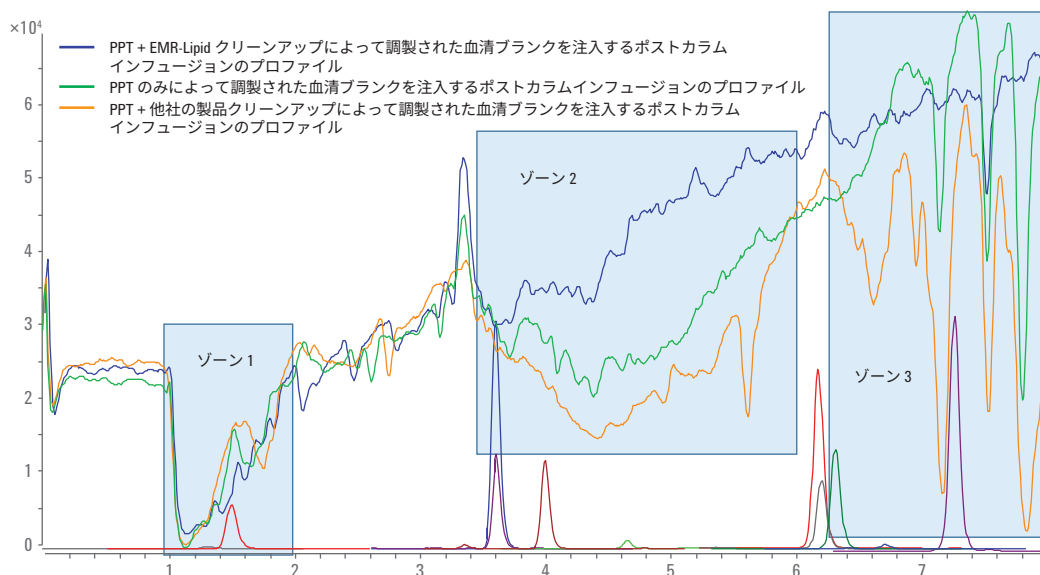
図6. 標準ポストカラムインフュージョンのプロファイルの比較とターゲット化合物に対するマトリックスイオン抑制効果の実証
