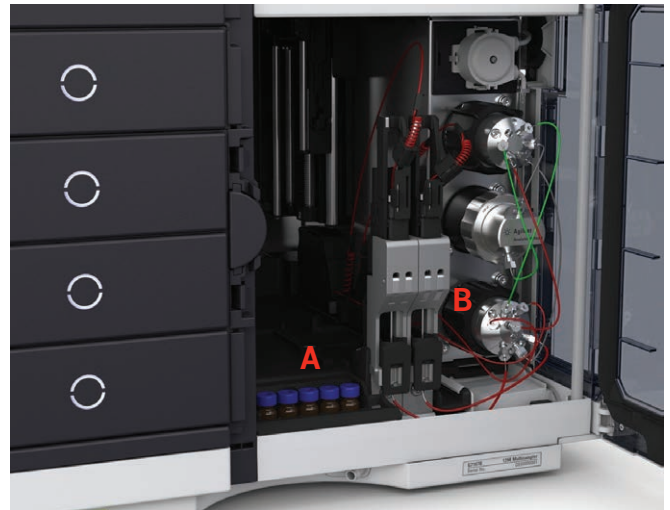
그림 3. PFAS 분석을 위한 Agilent 1260 Infinity II 또는 Agilent 1290 Infinity II multisampler 개조. A) 바이알과 캡, B) rotor seal. PFAS 분석 전에 LC를 이미 사용하였다면, 고정자(stator) 헤드도 교체하십시오. 참고: 그림에서는 이중 니들 어셈블리를 나타내었으나, 단일 니들 구성으로도 분석 수행 가능
