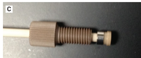
그림 1. 용매 용기에서 펌프로 이어지는 PEEK 튜빙 설치
