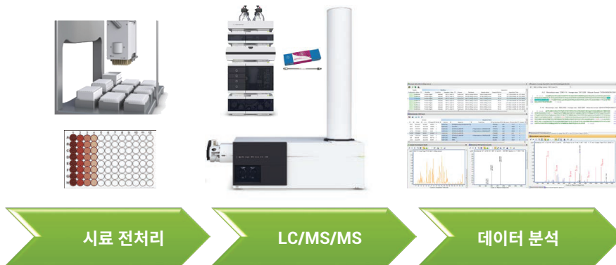
그림 1. Agilent AssayMAP Bravo 플랫폼에서 자동화된 시료 전처리부터 Agilent 6550 Q-TOF LC/MS/MS 분석 및 Agilent BioConfirm B.08까지 펩티드 맵핑 단일 클론 항체의 통합 워크플로
