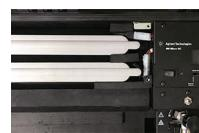
充电电池可支持长达 8 小时的操作。在适当情况下，还可转换至外部电源供电。
