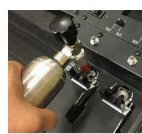
由两个充气式气瓶供应操作气体，用户可配置为双载气或双倍体积的单一载气。使用快速接头可实现一键更换。
