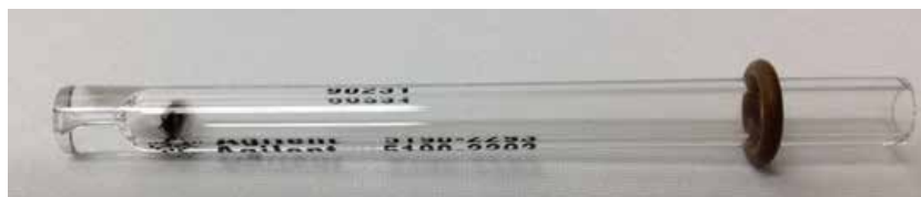
Figura 12. Liner empaquetado con lana de vidrio tras 20 inyecciones de matriz.
