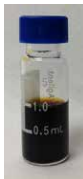
Figura 10. Extracto de suelo con diclorometano.
