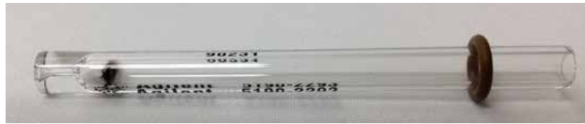
Abbildung 12. Mit Glaswolle gepackter Liner nach 20 Matrixinjektionen.
