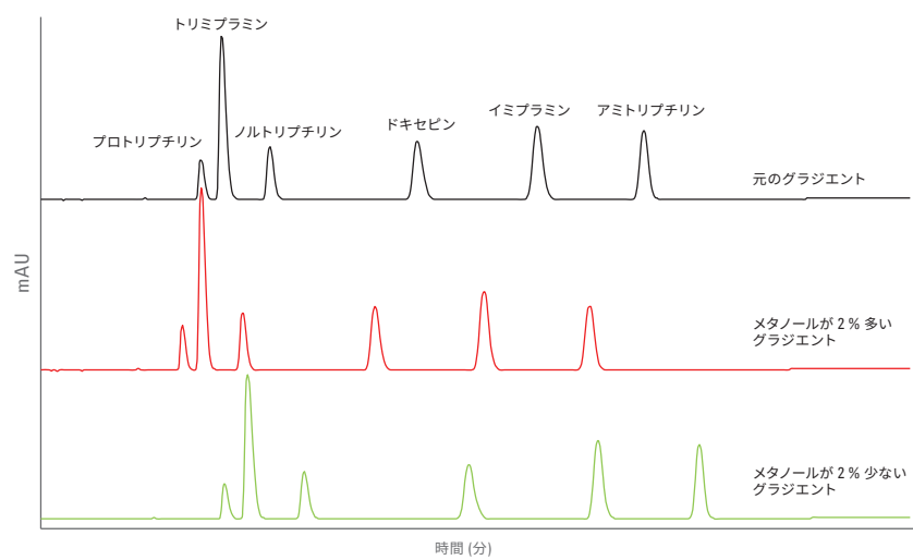
図 2. Agilent 1200 シリーズクォータナリ LC システムによる三環系抗うつ薬の従来の LC 分析: 元のグラジエントならびにメタノールを 2 % 多く含む場合およびメタノールを 2 % 少なく含むグラジエントの場合
