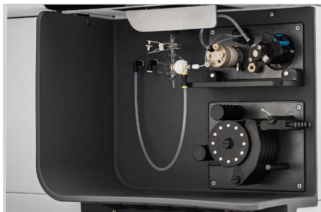
图 1. 安捷伦高级阀系统 (AVS) 六通阀
