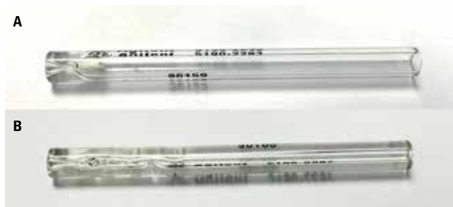
Figura 4. Aparência típica de liners do injetor de GC após 100 injeções de amostras de abacate preparadas pela limpeza de EMR—Lipídios seguida do pós-tratamento avançado. A) Liner splitless de cone único com lâ Agilent Ultra Inert, B) Liner com reentrâncias Agilent UI.
