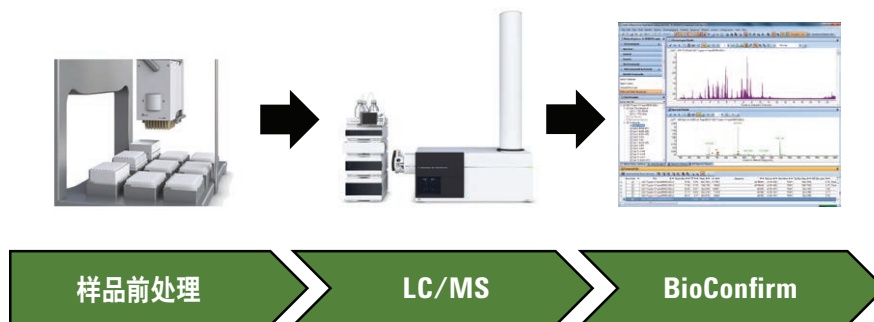
图 1. 使用 Agilent AssayMAP Bravo 和 Agilent 1290 Infinity LC/MS 系统的 ADC 肽谱分析工作流程
