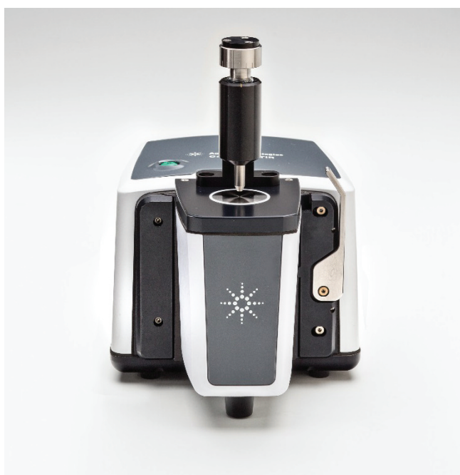
図 1. ATR サンプリングアクセサリを装着した Agilent Cary 630 FTIR
