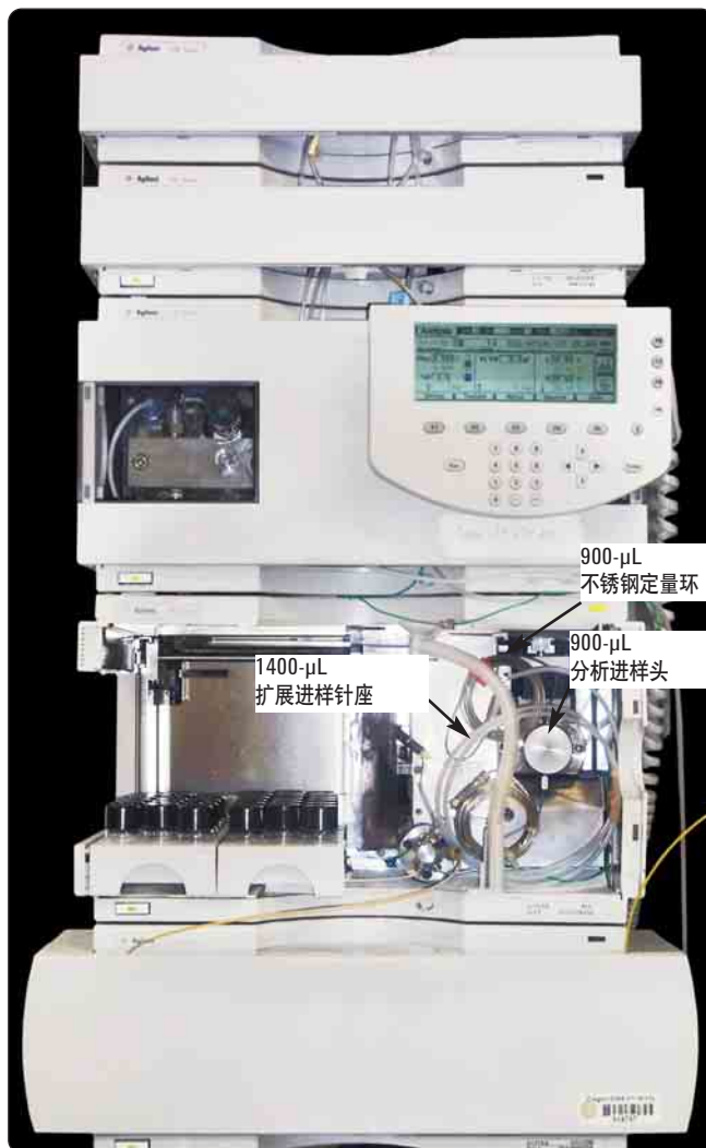
图 2. 配置了大体积进样升级套件的 G1313A 型自动进样器的 1100 液相色谱系统（面板已经拿掉）
