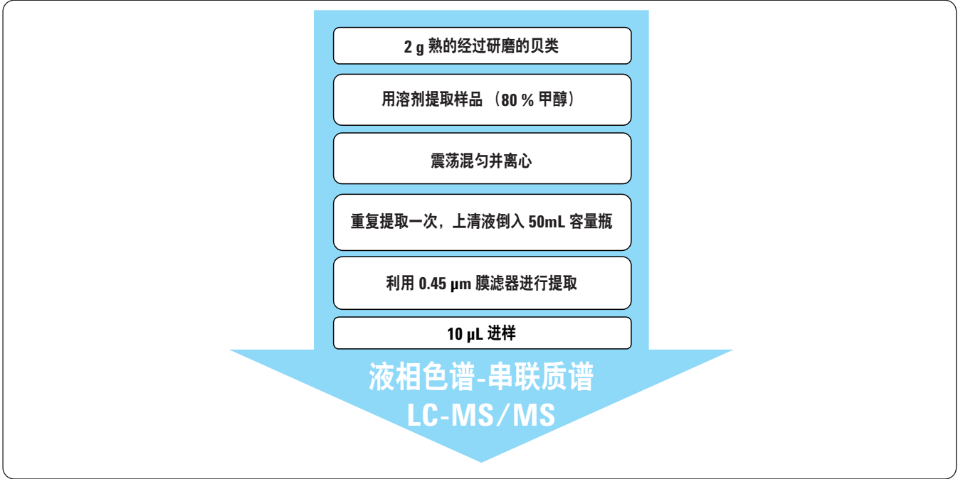
图 2. 检测贝类中海洋生物毒素过程中的样品前处理步骤
