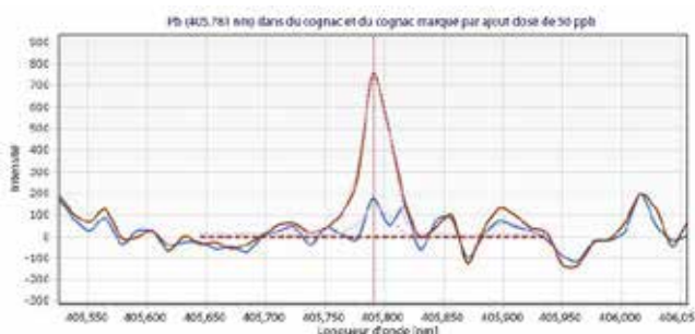
Figure 4. Spectre pour le Pb 405,781 nm dans l'échantillon de Cognac non dopé et dopé à 0,05 ppm
