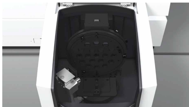
図 1a. ソリッドオートサンプラを取り付けた Cary 7000 UMS 測定チャンバ
