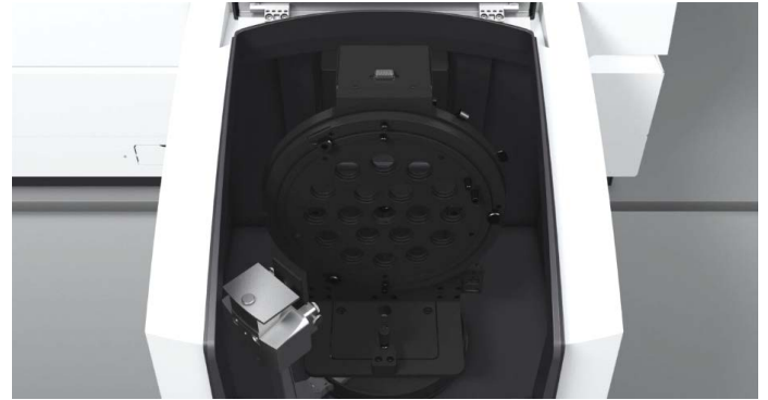
그림 1a. 교체 자동 시료 주입기가 탑재된 Cary 7000 UMS 측정 챔버의 개요도.
