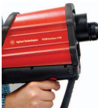
图 1. 配有漫反射采样接口的用于测量复合材料的 Agilent 4100 ExoScan FTIR 光谱仪
