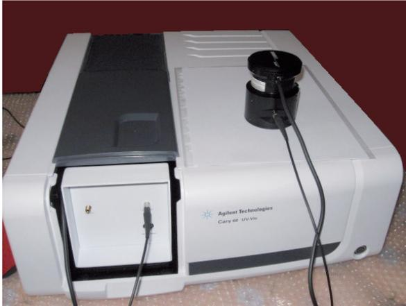
图 1. 配有远程光纤漫反射附件 (DRA) 的 Agilent Cary 60 紫外-可见分光光度计
