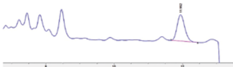
Рисунок 3. Хроматограмма чистой плазмы с прибавлением стандартного раствора капецитабина (10 мкг/мл)
