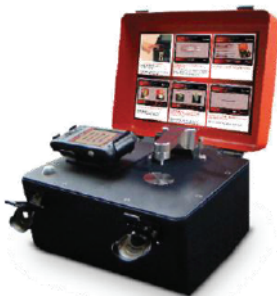
그림 1. 다이아몬드 ATR 시료 인터페이스를 갖춘 Agilent 4500a 시리즈 FTIR 휴대용 분광기. 이 시스템은 배터리 작동식이고, 무게는 15 lbs뿐이며 탁월한 휴대성 갖춘
