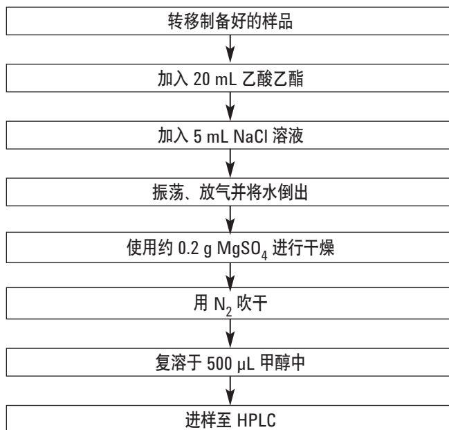
图 3. 使用 LLE 通过分液漏斗萃取洗发水/沐浴露中对羟基苯甲酸酯的步骤
