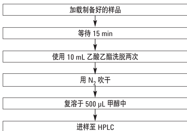
图 2. 使用 SLE 萃取洗发水/沐浴露中对羟基苯甲酸酯的步骤
