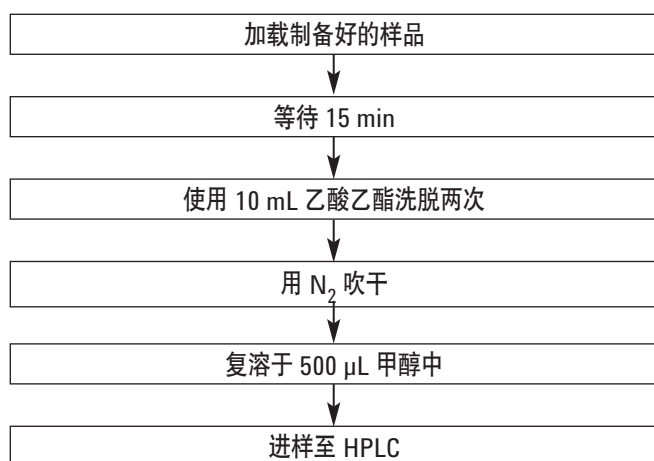
图 2. 使用 SLE 从洗发水/沐浴露中萃取邻苯二甲酸酯的步骤
