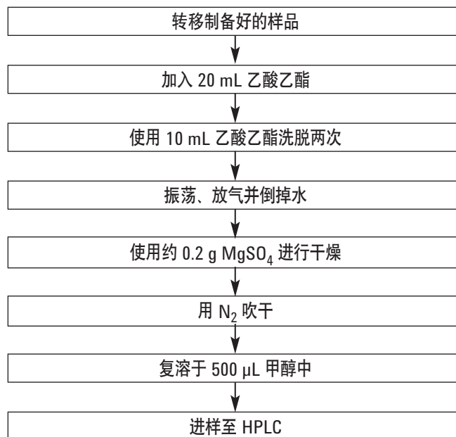
图 3. 使用 LLE 通过分液漏斗从洗发水/沐浴露中萃取邻苯二甲酸酯的步骤
