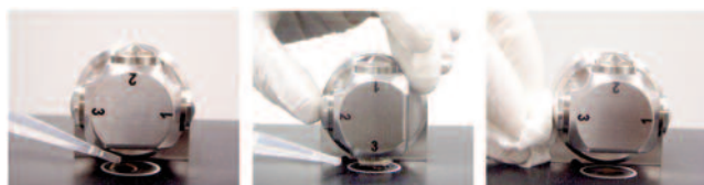
图 2. DialPath 的操作。将样品放到窗片上; 转动第二个窗片进入相应位置; 分析样品; 擦拭清洁窗片
