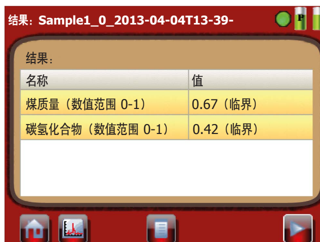
图 7：煤质量判定方法表明，样品 1 刚好通过了长石比率“煤质量”和碳氢化合物含量测定（黄色 - 略可接受）
