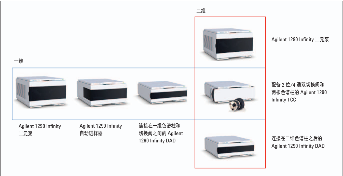
图 1 用于中心切割 2D-LC 应用 (LC-LC) 的仪器配置。该配置中，一维和二维的泵是完全相同的。通常来说，二维泵必须是 1290 Infinity 泵，以实现二维色谱柱的快速梯度洗脱。而一维泵的选择就比较灵活，也可以是 1260/1290 Infinity 四元泵或 1260 Infinity 二元泵
