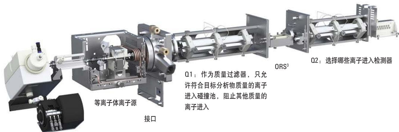
图 1. Agilent 8800 电感耦合等离子体串联质谱仪图解
