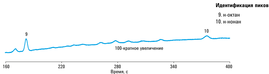
Рисунок 2б. Хроматограмма для углеводородов C8 – C9 на колонке CP-Sil 5 CB, 6м.
