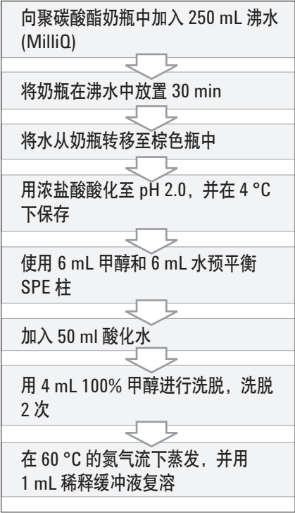
图 2 从奶瓶中提取 BPA 并使用 SPE 进行样品前处理
