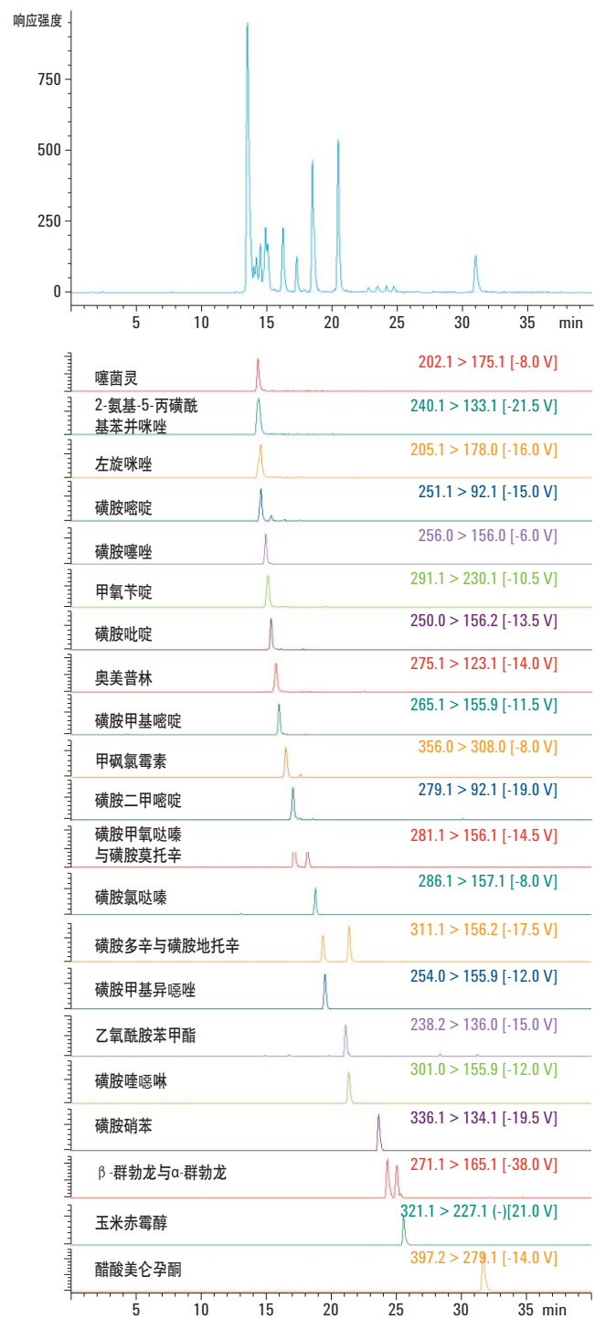
图 1. 使用 Agilent Pursuit C18 色谱柱进行方法 (I) 中标准品的 LC-MS/MS 分析的总离子流色谱图和 MRM 色谱图
