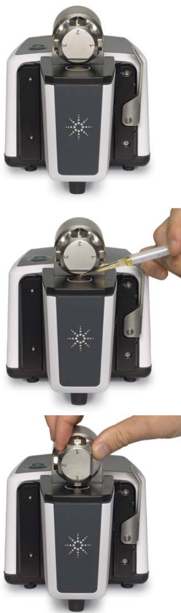
图 2. 液体样品分析。使用 DialPath 模块进行分析的三个步骤
