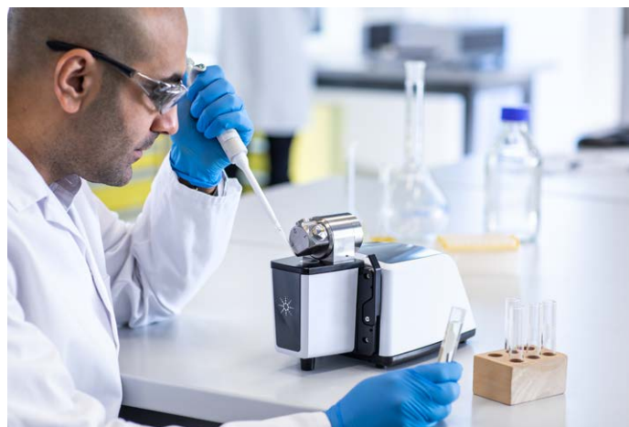
图 3. 配置安捷伦专有 DialPath 采样模块的 Agilent Cary 630 FTIR 分光光度计。Cary 630 是一款超级紧凑、使用方便的高性能 FTIR 光谱仪。配置 DialPath 技术后，将成为液体样品分析的强大仪器
