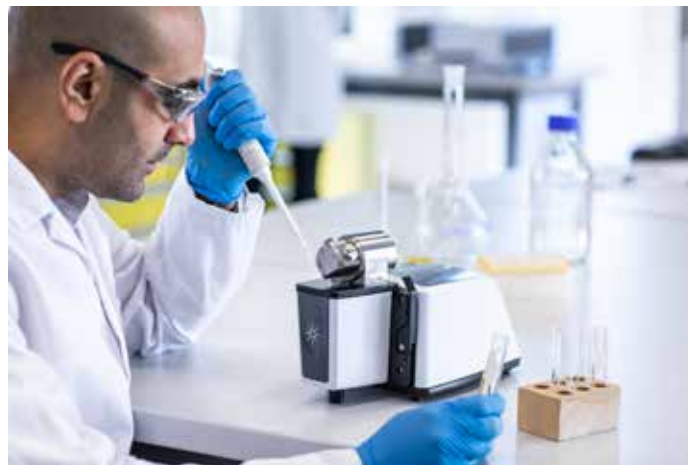
Figura 3. Espectrômetro FTIR Agilent Cary 630 equipado com o módulo de amostragem DialPath exclusivo da Agilent. O Cary 630 é um espectrômetro FTIR ultracompacto, fácil de usar e de alto desempenho. Combinado com a tecnologia DialPath, é um poderoso instrumento para a análise de líquidos.
