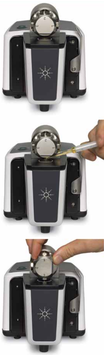
Figura 2. Análise de amostras líquidas. As três etapas para análise com o módulo DialPath.
