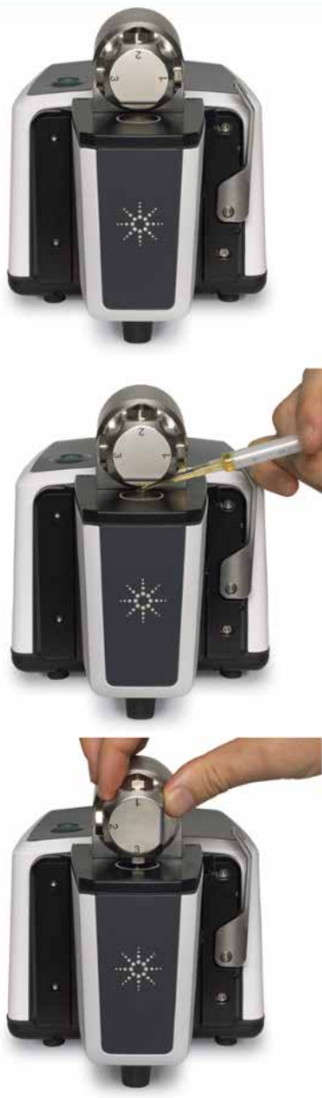
Figura 2. Analisi di campioni in soluzione. Le tre fasi dell'analisi con il modulo DialPath.
