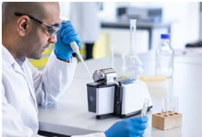
Figure 3. Spectromètre FTIR Agilent Cary 630 équipé du module d'échantillonnage exclusif d'Agilent DialPath. Le Cary 630 est un spectromètre FTIR haute performance, ultra-compact et facile à utiliser. Associé au module DialPath, il constitue un système performant d'analyse des liquides.
