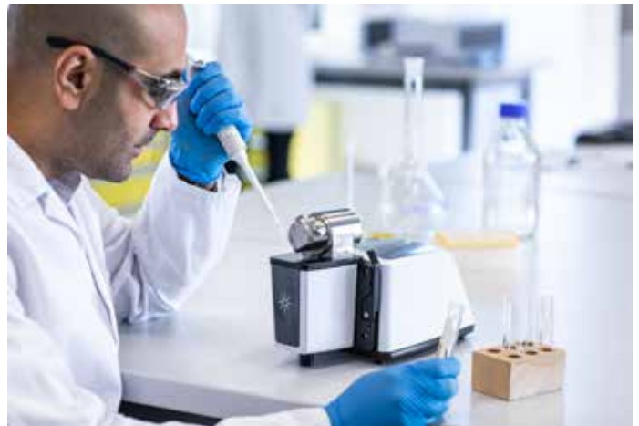
Figura 3. Espectrómetro FTIR Agilent Cary 630 equipado con el módulo de muestreo DialPath, exclusivo de Agilent. El sistema Cary 630 es un espectrómetro FTIR ultracompacto, de alto rendimiento y fácil de usar. En combinación con la tecnología DialPath, es un avanzado instrumento para el análisis de líquidos.
