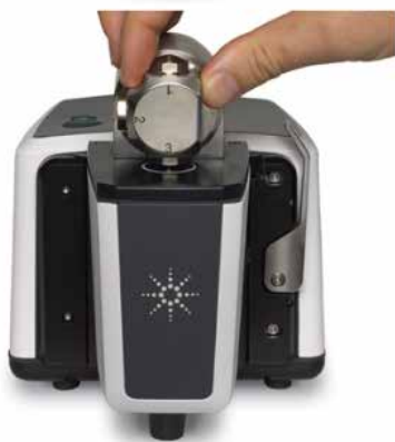
Abbildung 2: Analyse flüssiger Proben. Drei Schritte für die Analyse mit dem DialPath-Modul.
