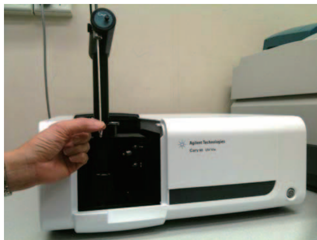
图 1. 配有光纤附件的 Cary 60 测试 4 °C 下 Eppendorf 管中 150 µL DNA 的示意图。
