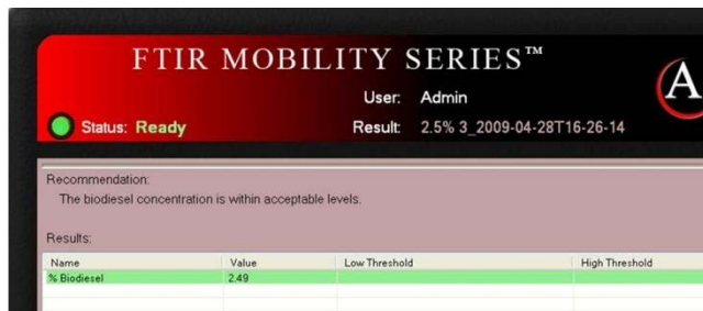
图 5. 生物柴油体积浓度为 2.50% 的柴油样品的 Microlab 结果屏显
