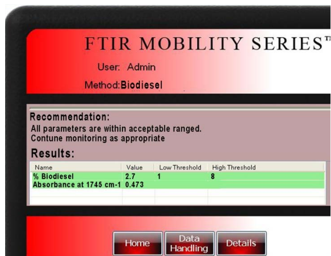
图 4. 含 3.0% 生物柴油的柴油样品的 MicroLab 结果屏显
