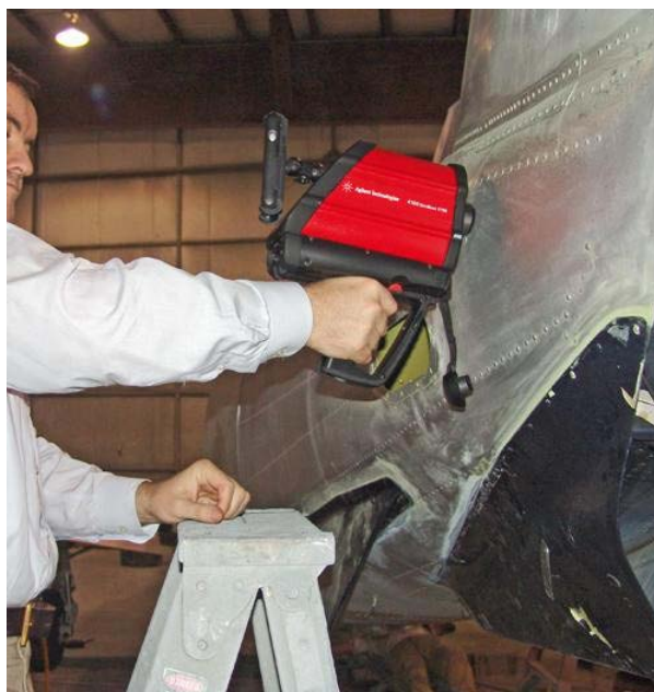
图 1. 使用带镜面反射探头的手持式 Agilent 4100 ExoScan FTIR 对飞机涂层进行现场质量检验
