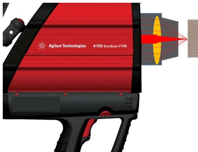
图 2. 漫反射探头附件采用广角设计实现了高效漫散射光的收集。另外，慢聚焦使得景深更大，这样即使样品离光束焦点有几毫米远也可以实现数据采集。这两个特点使手持红外对表面不平整或不光滑的真实样品的检测分析变得非常容易。
