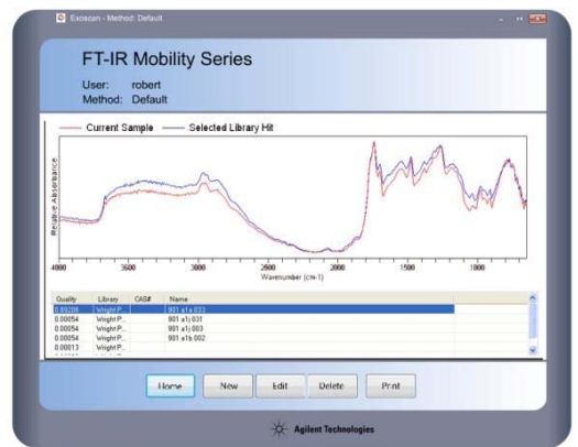
图 5. 聚合物涂层成品的谱库检索结果
