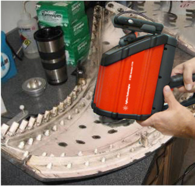
图 5. 使用 4100 ExoScan 系统测量因发动机起火而损坏的复合材料飞机部件的热损伤。
