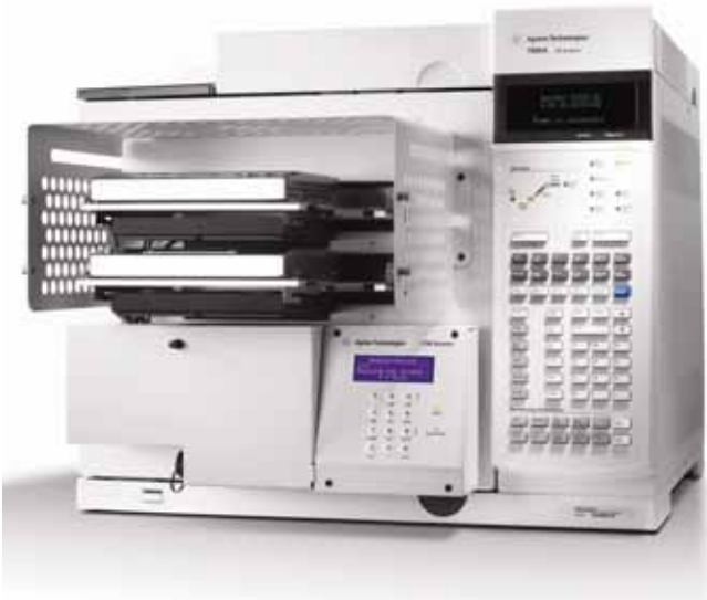
图 2. 低热容(LTM)色谱柱模块与安捷伦 7890A 嵌接
